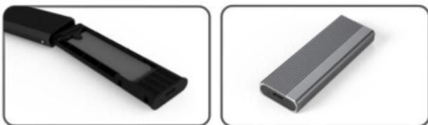
5. Inclinez le support interne à encliquetage à 45° et enfichez-le dans le boîtier externe du disque dur, remplacez-le dans sa position d'origine, appuyez vers le bas jusqu'à ce que vous entendiez un clic correspondant au verrouillage automatique, l'installation est alors terminée.
