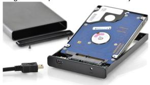
3. Deslice el disco duro hacia dentro y fije la bandeja con tornillos
