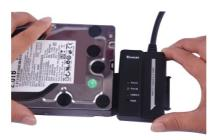
2. Verbinden Sie das Kabel mit dem USB-Anschluss des Computers.
