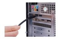
Schließen Sie das Netzteil an. Stellen Sie die Stromversorgung an der Festplatte her. Schalten Sie das Gerät ein. Die IDE-Festplatte wird nun erkannt.
