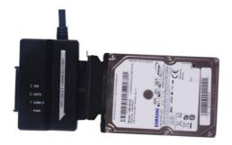
3. Schließen Sie das USB-Kabel am Computer an.
