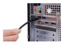
3. Schließen Sie das Netzteil an. Die SATA-Festplatte wird nun erkannt.
