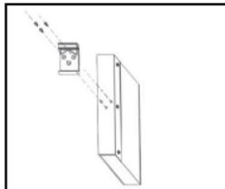
Verwenden Sie die mitgelieferten Schrauben, um das DIN-Schienen-Kit an der Rückseite des HUBs zu befestigen.
