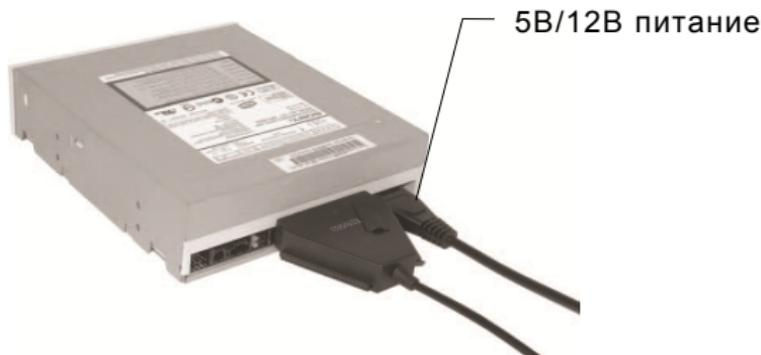
Для 5.25 CD/DVD устройства подключите напрямую 40контактный разъем к соответствующим портам на задней панели CD/DVD устройства, и подключите USB разъем сигнала /данных (Черный) в USB порт ПК, затем подключите 4-контактный разъем питания к 4-контактному гнезду питания (для IDE CD/DVD напрямую подключите разъем питания CD/DVD), а другой конец подключите к источнику питания.
