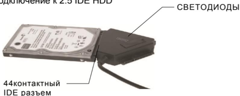
Для 2.5 SATA HDD или IDE HDD, подключите непосредственно разъем SATA или 44контактный разъем в соответствующие порты на задней панели HDD, и подключите USB разъем для сигнала /данных (Черный) в USB порт ПК.
