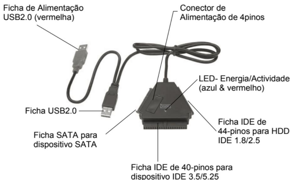
Nota: Para o dispositivo IDE 3.5/5.25, o cabo de alimentação insere diretamente na porta apropriada na parte traseira do HDD ou do DVD, por isso a ficha de ligar/desligar não pode controlar a corrente para o disco rígido ou DVD. Se quiser cortar a corrente para o disco rígido ou DVD, precisa e desconectar a ficha da tomada do HDD IDE 3.5 " ou dos dispositivos DVD 5.25.
