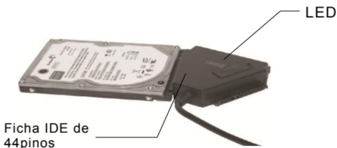
Para um HDD SATA 2.5 ou HDD IDE, conecte diretamente o conector SATA ou o conector de 44 pinos nas portas apropriadas da parte traseira do HDD, e ligue a ficha USB de dados/sinal (Preto) na porta USB do PC.
