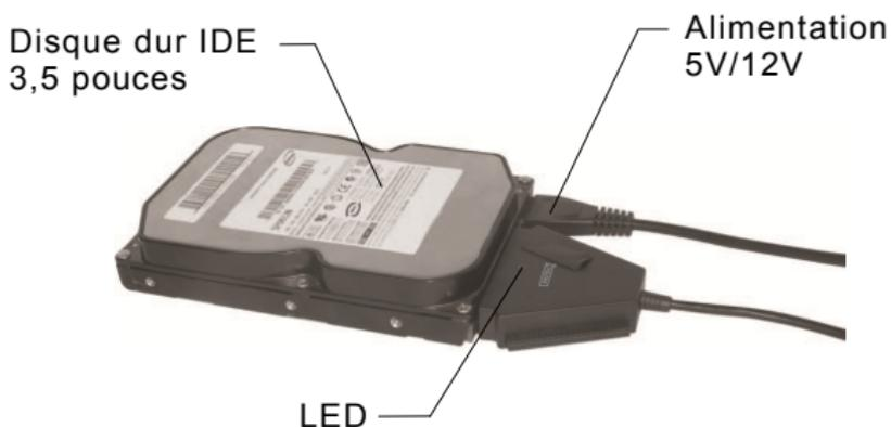
Pour un disque dur SATA ou IDE 3,5 pouces, branchez directement le connecteur SATA ou le connecteur 40 broches sur le port approprié à l'arrière du disque dur, puis branchez le connecteur de signal/données USB (noir) sur un port USB libre de l'ordinateur. Branchez la prise d'alimentation 4 broches sur le connecteur 4 broches correspondant (pour un disque dur IDE, branchez directement sur le connecteur d'alimentation du disque) et branchez l'autre extrémité sur une source d'alimentation.
