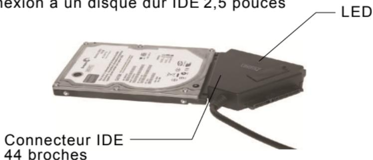
Pour un disque dur SATA ou IDE 2,5 pouces, branchez directement le connecteur SATA ou le connecteur 44 broches sur le port approprié à l'arrière du disque dur, puis branchez le connecteur de signal/données USB (noir) sur un port USB libre de l'ordinateur.
