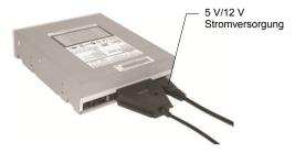
Stecken Sie bei einem 5,25"-CD/DVD-Laufwerk den 40-poligen Stecker direkt in den entsprechenden Anschluss auf der Rückseite des Laufwerks und stecken Sie den USB-Signal-/Daten-Stecker (schwarz) in den USB-Anschluss des PC's. Schließen Sie dann den 4-poligen Stecker des Netzteils an den 4-poligen Stromanschluss (bei IDE-CD/DVD-Laufwerken direkt an den Stromanschluss des Laufwerks) und den Stecker am anderen Ende an das Netzteil an.
