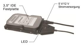
Stecken Sie bei einer 3,5"-SATA- oder IDE-Festplatte den SATA-Stecker oder den 44-poligen Stecker direkt in den entsprechenden Anschluss auf der Rückseite der Festplatte und stecken Sie den USB-Signal-/Daten-Stecker (schwarz) in den USB-Anschluss des PC's. Schließen Sie dann den 4-poligen Stecker eines Netzteils (nicht im Lieferumfang enthalten) an den 4-poligen Stromanschluss (bei IDE-Festplatten direkt an den Festplatten-Stromanschluss) und den Stecker am anderen Ende an das Netzteil an.
