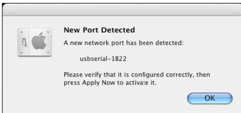
Нажмите ОК и выберите из списка Конфигурация сетевого порта. Новый порт может быть включен установкой пометки в боксе Вкл. и нажатием Применить.
