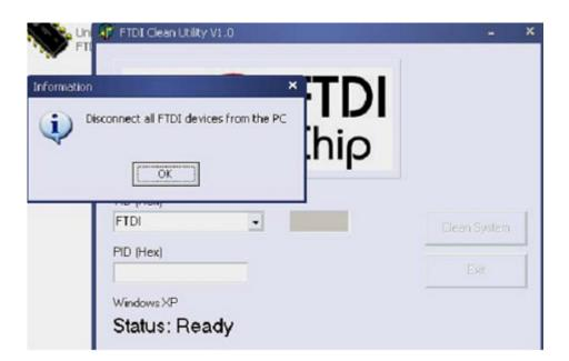
4. USB için Serial Converter aygıtını bilgisayardan çıkarıp, "OK" düğmesine tıkladığınızda aşağıdaki arayüz belirir; "Yes" düğmesine tıklayın
