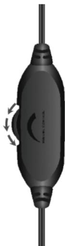
Achten Sie vor dem Aufsetzen des Headsets darauf, dass der Lautstärkeregler an der Kabelfernbedienung auf minimale Lautstärke gestellt ist.
