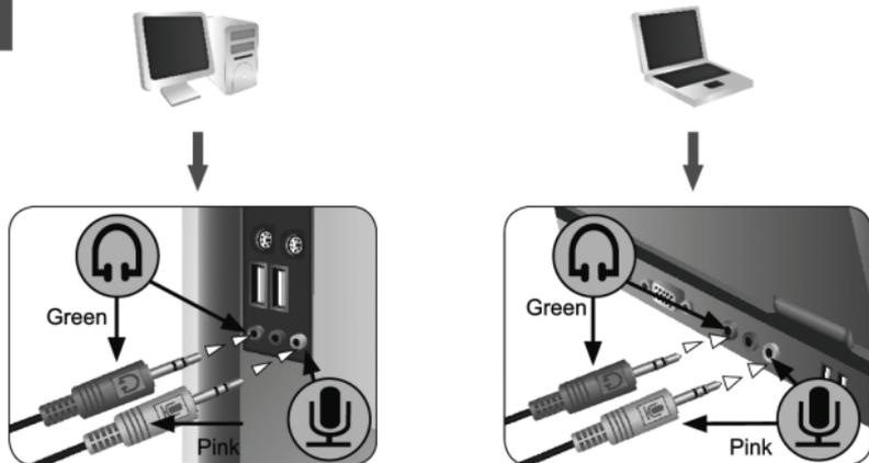
Entfernen Sie die Schutzkappen und schließen Sie die Klinkenstecker des Headsets an die Soundkarte an. Achten Sie darauf, dass der Kopfhörerstecker an den Lautsprecherausgang und der Mikrofonstecker an den Mikrofoneingang der Soundkarte angeschlossen sind.
