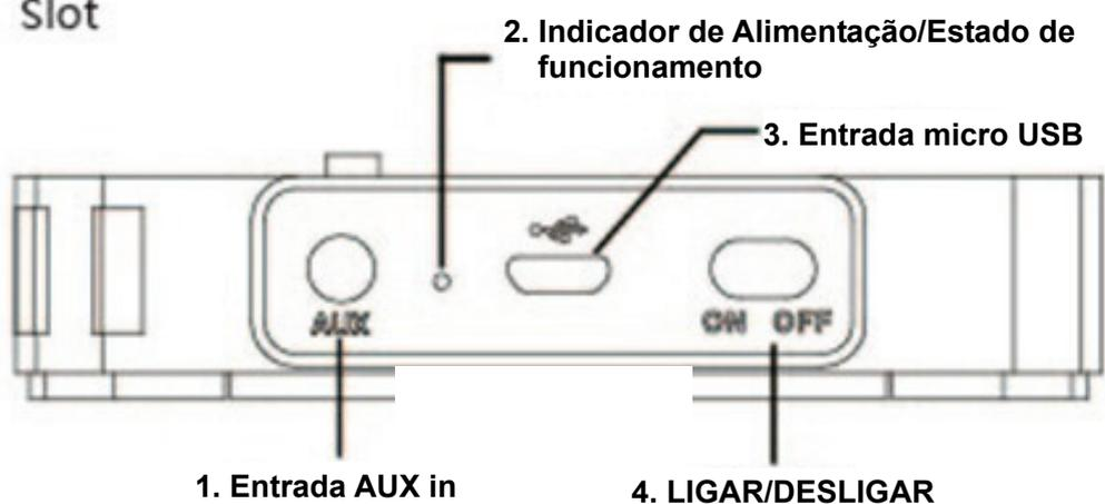
1. **Entrada AUX in:** Introduzir um cabo áudio de 3,5 mm, premir **M** “Modo Aux in”. O dispositivo funcionará como uma coluna externa da fonte áudio do computador, PSP/MP4, etc.
