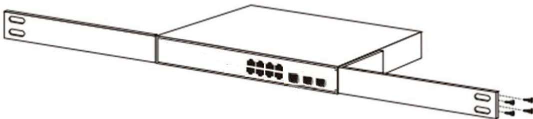
Abbildung 4 - Installation der Halterungen
