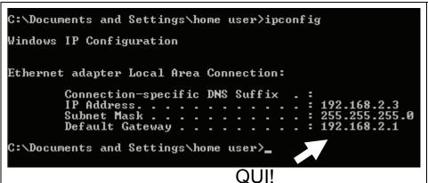
5. Inserite 'ipconfig', quindi premete il tasto 'Invio'. Controllate l'indirizzo IP seguito da 'Default Gateway' (In questo esempio, l'indirizzo IP del router è 192.168.2.1)
