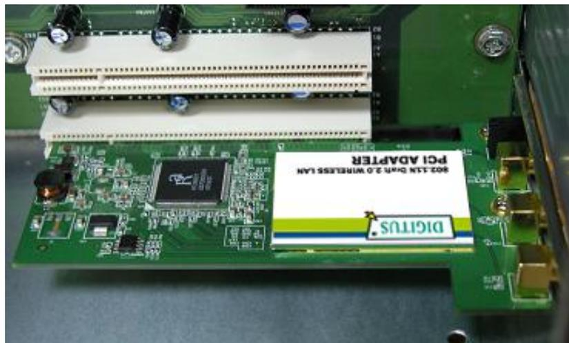
1. Schalten Sie Ihren Computer aus, und entfernen Sie gegebenenfalls das Gehäuse, so dass Sie die PCI-Steckplätze sehen können (PCI-Slots sind gewöhnlich in weißer Farbe), und setzen Sie dann die PCI Drahtlos-Netzwerkkarte in einen verfügbaren PCI-Slot ein.
