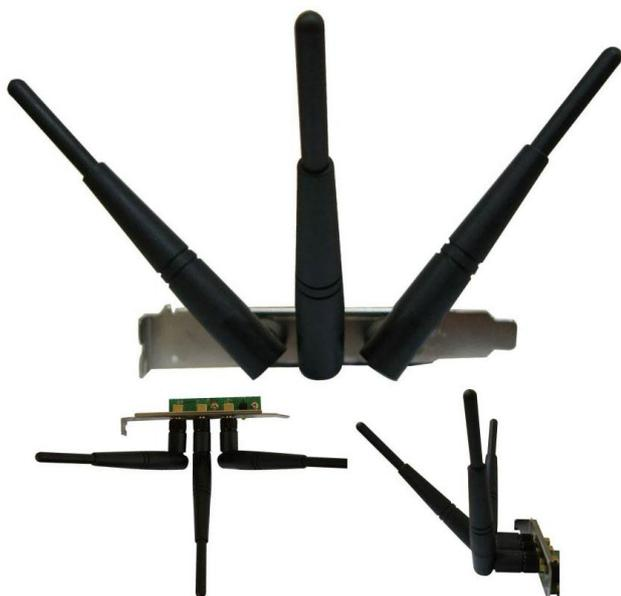
2. Bauen Sie alle drei Antennen auf der Drahtlos-Netzwerkkarte ein, und stellen Sie sicher, dass die Antennen sicher eingebaut sind. Um den Radio-Empfang zu verbessern, stellen Sie bitte die Antennen auf die Position ein, die in der Abbildung links zu sehen ist.
