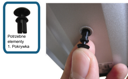
Rysunek 5: Założyć pokrywkę na kamerę
