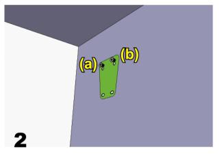
Kleben Sie den mitgelieferten Installationsaufkleber auf die Stelle, wo Sie die Kamera installieren möchten. Entsprechend Ihrer Montageumgebung bohren Sie ein Loch in der Mitte des Aufklebers für das spätere Durchführen des Strom- und Videokabels, falls notwendig.
