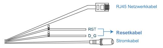
Bitte beachten Sie: Zum Betrieb des Geräts benötigen Sie ein DC 12 V Netzteil.
