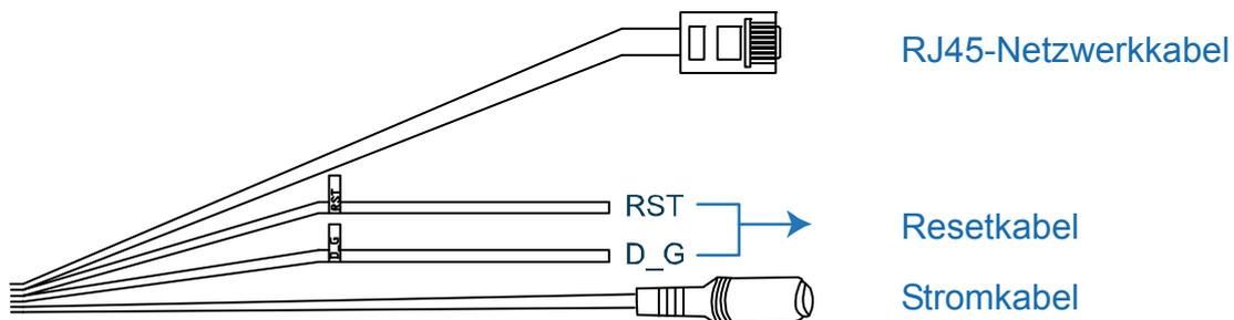
**Bitte beachten Sie:** Zum Betrieb des Geräts benötigen Sie ein DC 12 V Netzteil.
