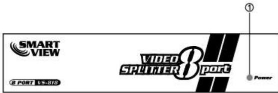
1. Betriebsanzeige. Die LED leuchtet sobald der Video Splitter mit Spannung versorgt wird.
