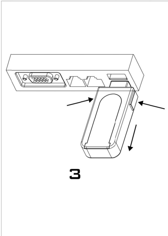
**Schritt 4:** Der USB 1.1/2.0/3.0 Port wird mit dem Schloss blockiert
