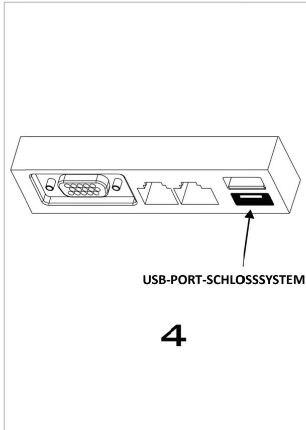
**Schritt 5:** Stecken Sie den Schlüssel in den blockierten USB-Port und ziehen Sie ihn heraus
