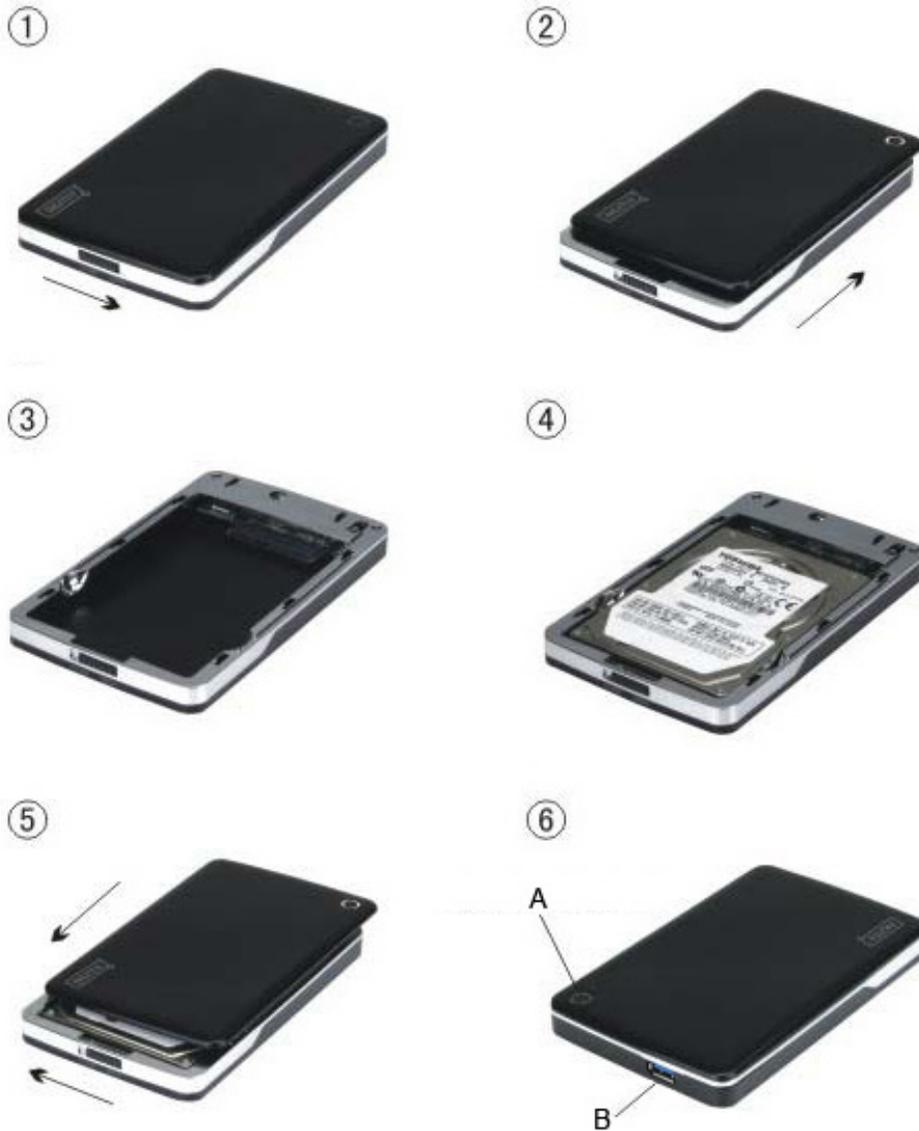
A. Индикатор питания/твёрдого диска | B. Разъём USB 3.0
