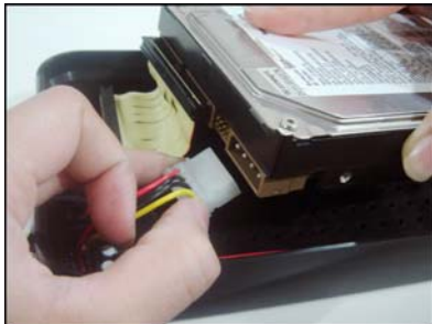
3. Setzen Sie die PATA-Festplatte mit dem HD-Netzkabel ein.
