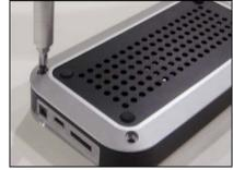
Drehen Sie Schrauben (2 längere, 2 kürzere) in das Unterteil des HD-Laufwerks ein, um es abzudichten.
