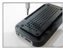
Schrauben am Unterteil des HD-Laufwerks fest anziehen, um die Festplatte zu befestigen (4 Kurzschrauben)
