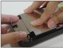
4. Setzen Sie die PCB-Abschirmung auf den PCBA.
