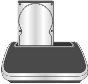
Instalación del HDD de 2.5”
