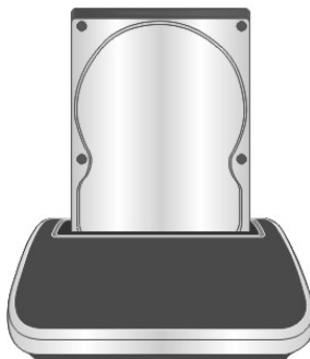
Установка 3.5" жесткого диска
