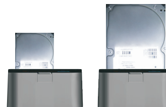
Installation de disque dur 2.5" Installation de disque dur 3.5"
